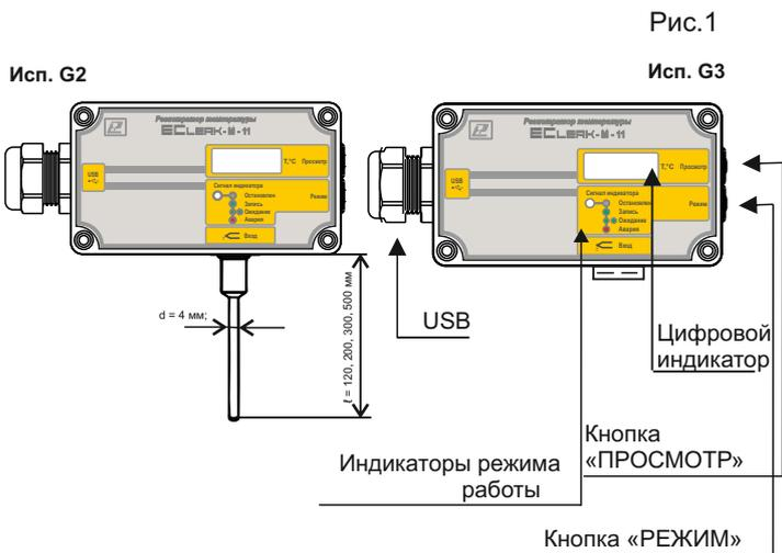
Прибор имеет герметичный разъём для подключения термопары ТХА (К).
